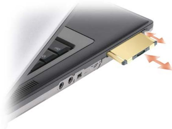
電腦能夠識別大多數 PC Card，並自動載入相應的裝置驅動程式。如果組態程式提示需要載入製造廠商提供的驅動程式，請使用 PC Card 隨附的軟碟或 CD。
