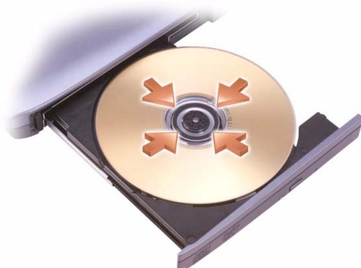
3 將光碟有標籤的一面朝上放入承載器的中央，並將光碟卡在轉軸上。
